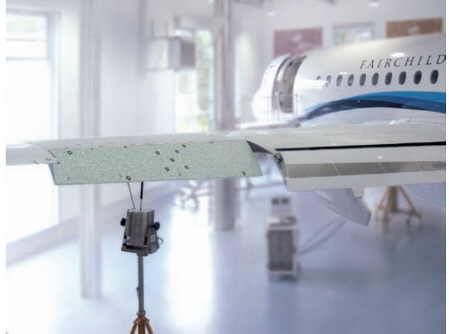
Probeaufbau zur Messung der Flügeldeformation an der Dornier Do 728 Seite 10
