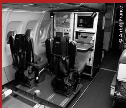
Permanente Basismessausrüstung im ATRA: Sicherheitsbestuhlung mit Pilotensitzen und 5-Punkt-Sicherheitsgurten
