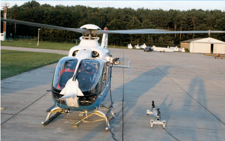
Hubschrauber-Probelauf: Der EC-135 ACT/FHS mit IPCT-Kamerasystem (am Hubschrauber rechts oben erkennbar)
