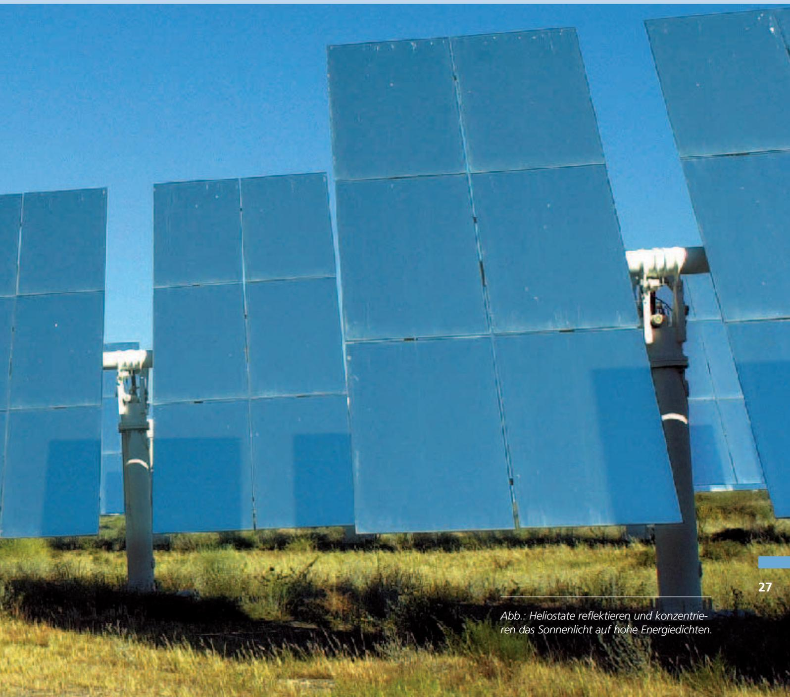
*Abb.: Heliostate reflektieren und konzentrieren das Sonnenlicht auf hohe Energiedichten.*
