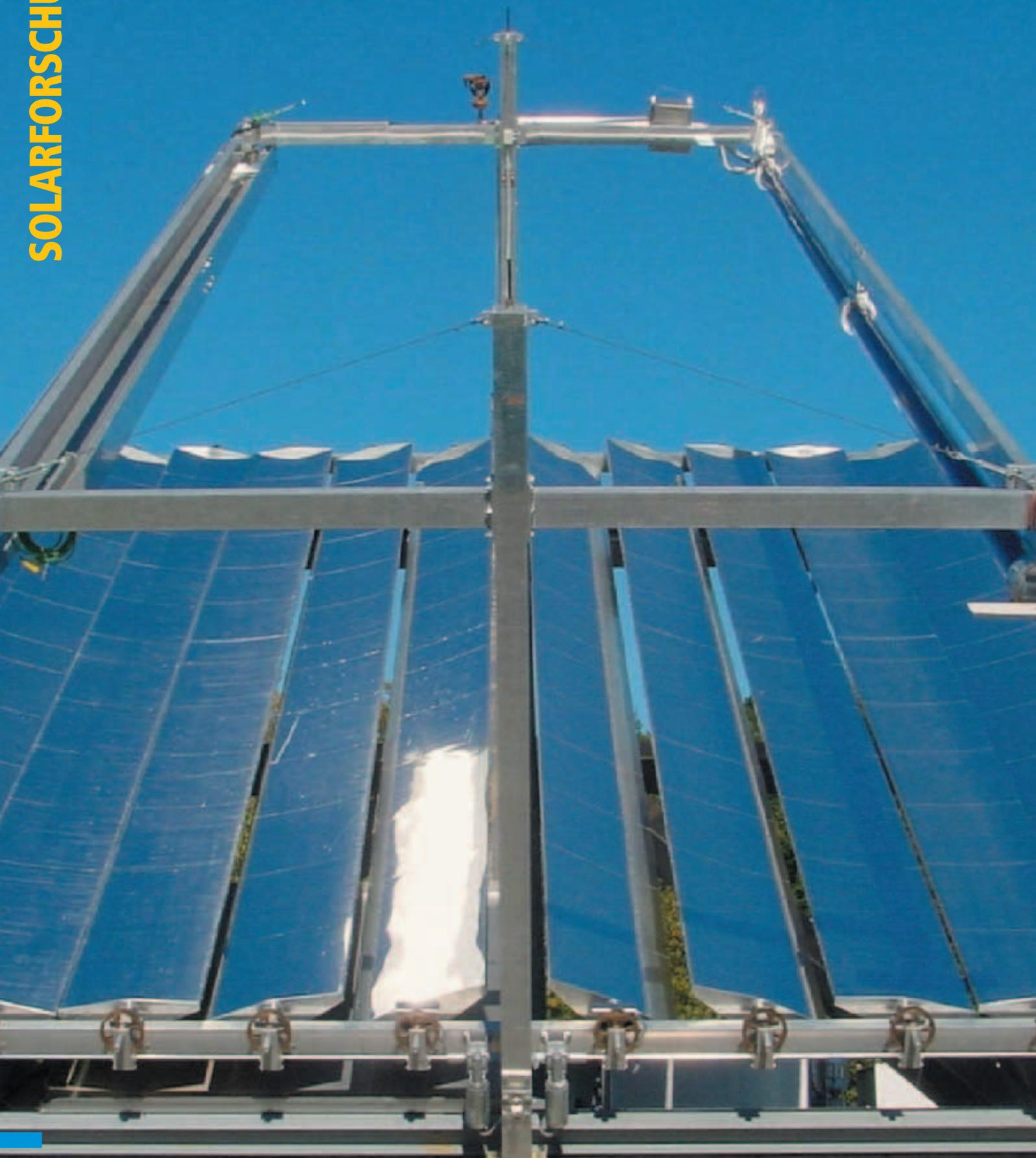
Abb. links: DLR-"Fix-Fokus-Rinne" – Facettierte Parabolreflektoren im Test.
