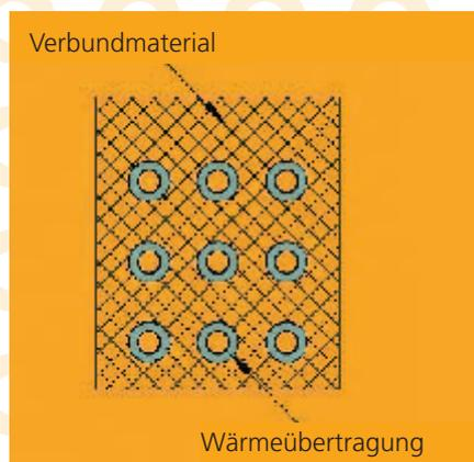
Abb.: Rohrregister mit externer PCM Anordnung.
