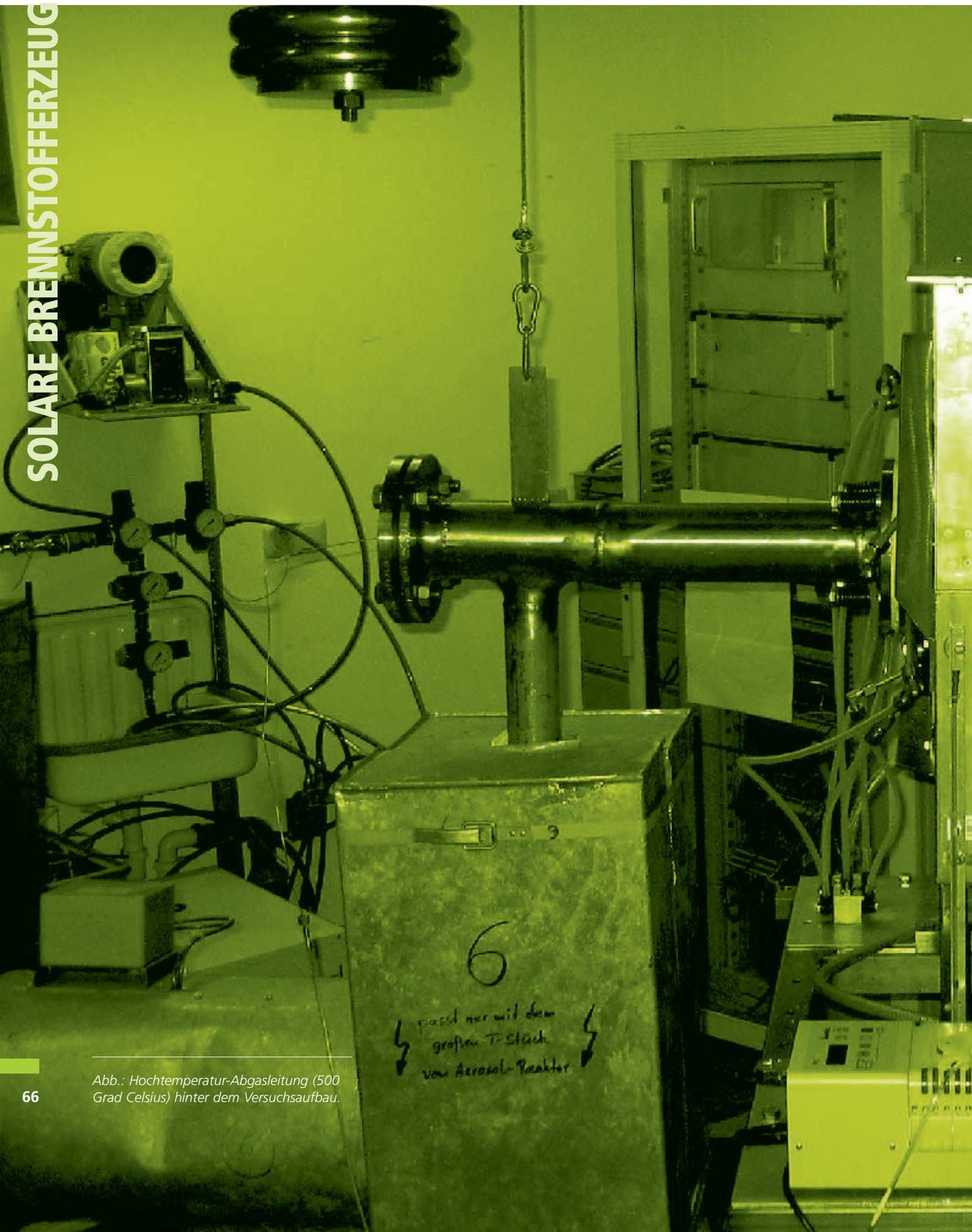
Abb.: Hochtemperatur-Abgasleitung (500 Grad Celsius) hinter dem Versuchsaufbau.
