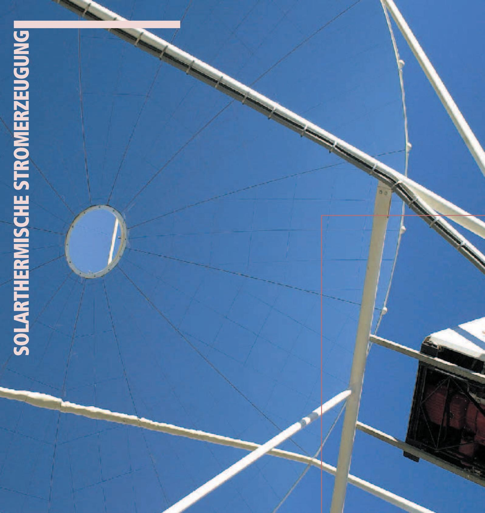
**S**tirlingmotoren können im Vergleich zu kleinen Dampf- oder Gasturbinen sehr hohe Wirkungsgrade von über 40 Prozent erzielen. Da anders als bei Explosionsmotoren die benötigte Energie von außen über einen Wärmetauscher („Receiver“) zugeführt wird, entstehen im Motorinnenraum keine Verbrennungsrückstände. Deshalb gelten sie als sehr wartungsarm und eignen sich hervorragend auch für die dezentrale
