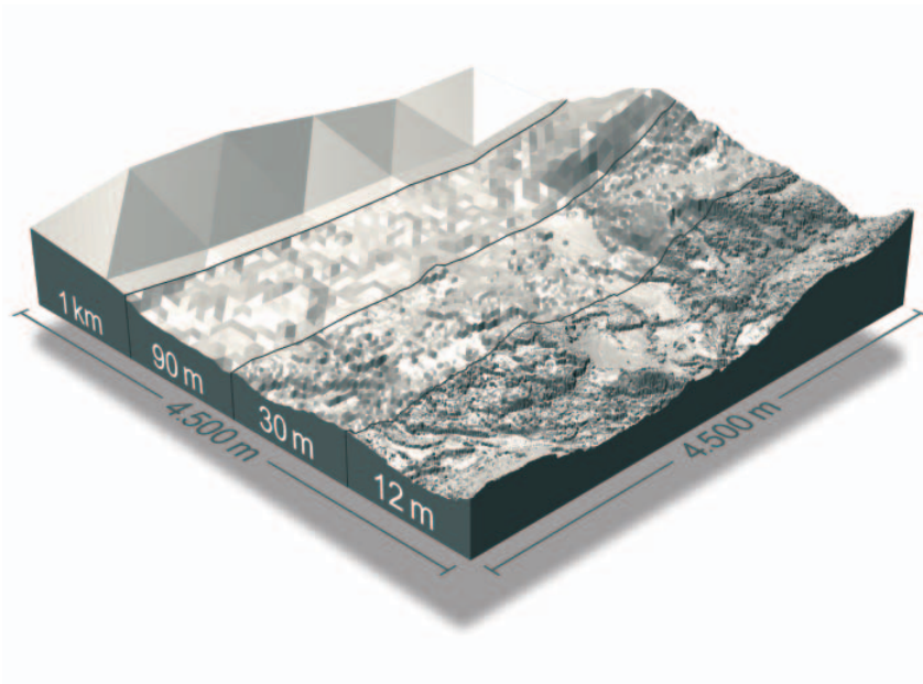
Die Genauigkeit von Höhenmodellen im Vergleich – von links nach rechts: 1 km – 90 m – 30 m – 12 m (= TanDEM-X).
