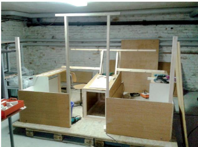
Anschließend wird die obere durchgängige Abschlussleiste des Panels montiert. Danach kommen die geteilten unteren Abschlussleisten an die Reihe. Dabei ist sorgfältig darauf zu achten, dass die jeweils rechte und linke Seite mit den in Flugrichtung zeigenden Vorderkanten der Seitenkonsolen verschraubt werden. Die durch den Winkel des Panels bedingten Freiräume sind an den Berührungspunkten mit Keilleisten aufzufüllen, bevor die Verschraubung erfolgt.
