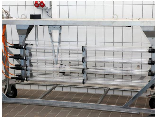
Abbildung 3: UV-Modul zur Wasserdesinfektion.
