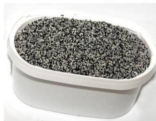
Abbildung 2: Filterkartusche: Oben geschlossen, unten offen. („Kartusche“ bedeutet im Allgemeinen „Behälter“).
