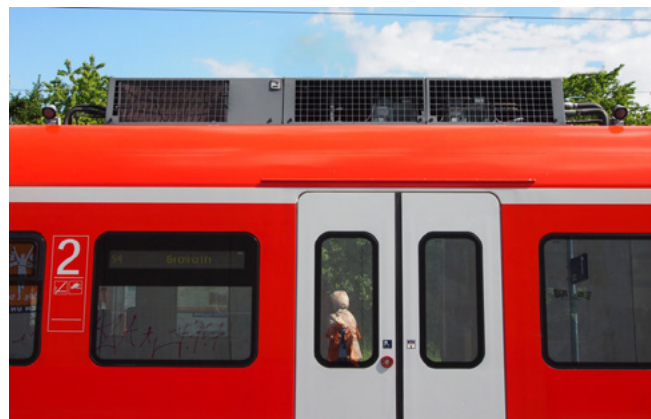
Abbildung 4: Klimaanlage auf einem Zugdach.
