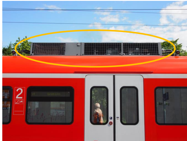
Abbildung 4: Klimaanlage auf einem Zugdach.
