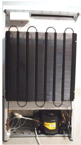
Abbildung 2: Der Kühlschrank von hinten. Man sieht die Rohrschleifen für das Kältemittel und die „Kühlrippen“ sowie den Kompressor (unten).
