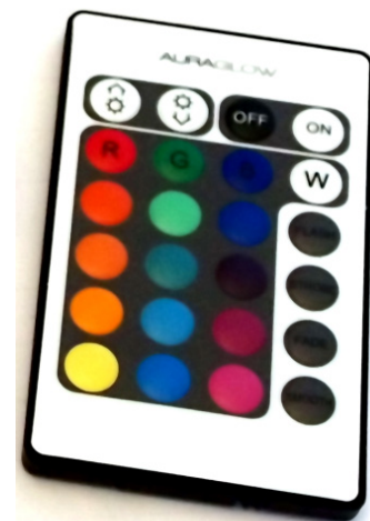
Abb. 7: Steuerkonsole für das Mischen der farbigen Wohnraumbeluchtung.
