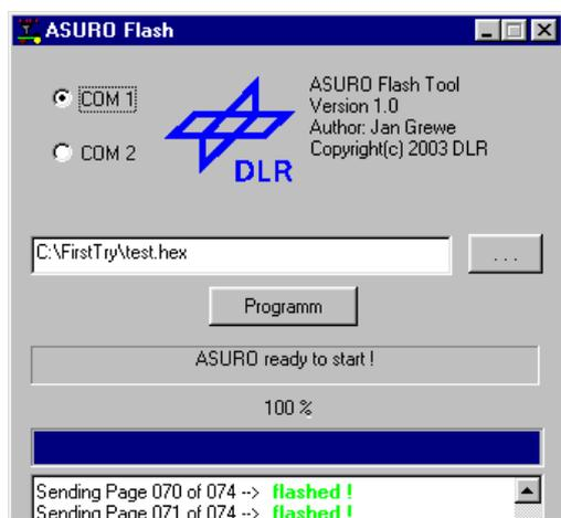
Installiert die Software von der ASURO-CD wie in der Anleitung beschrieben. Der ASURO wird in der Programmiersprache C programmiert und verfügt zusätzlich über einige vorbereitete ASURO-Funktionen. Nachdem ihr alles installiert habt und der Anleitung bis Seite 45 gefolgt seid, öffnet ihr die Datei; **test.c** im Programmiers Notepad! Es erscheint eine Maske, die ASURO-Funktionen übersetzt.
