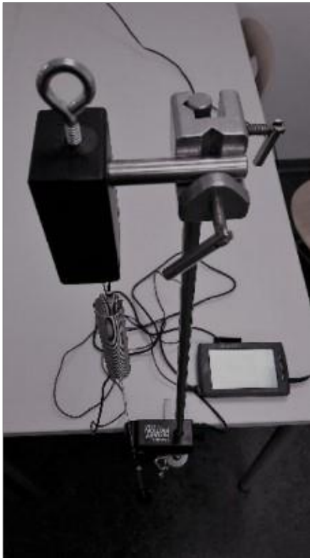
Abbildung D6.03 Versuchsaufbau zur Messung von Dehnung-Kraft-Diagrammen
