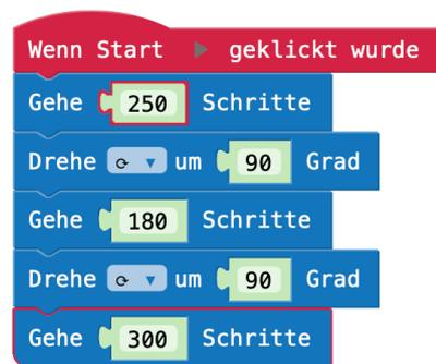
sodass sie beim zweiten **Drehe rechts um 90 Grad**-Baustein mit dem Hinterteil an die Ringelblumen stößt. Werden die Schritte auf **250** reduziert, wird das Problem behoben.
